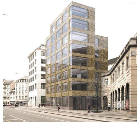
AUE-Visualisierung. Holzskelettbau, Decken in Holzbetonverbund (Recycling-Beton).
