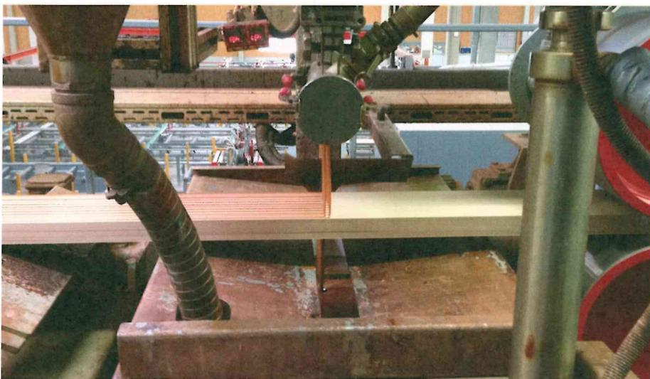
Der Leimauftrag auf die Baubuche-Lamellen: Sie werden zum Träger geschichtet und in der Balkenpresse verpresst. Sie kommen als Hochleistungsträger zum Einsatz.
