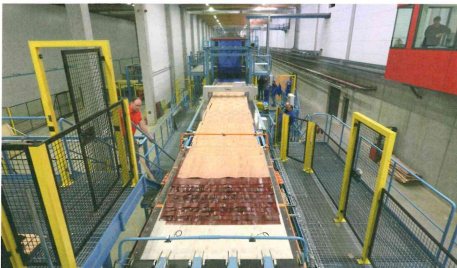
Die fertig gelegten Furnierschichtholzlagen vor dem Presseneinlauf: Deutlich sind die einzelnen Schichten zu erkennen. Sie werden bei einer Durchlaufzeit von 30 Minuten zu Baubuche-Platten verklebt.
