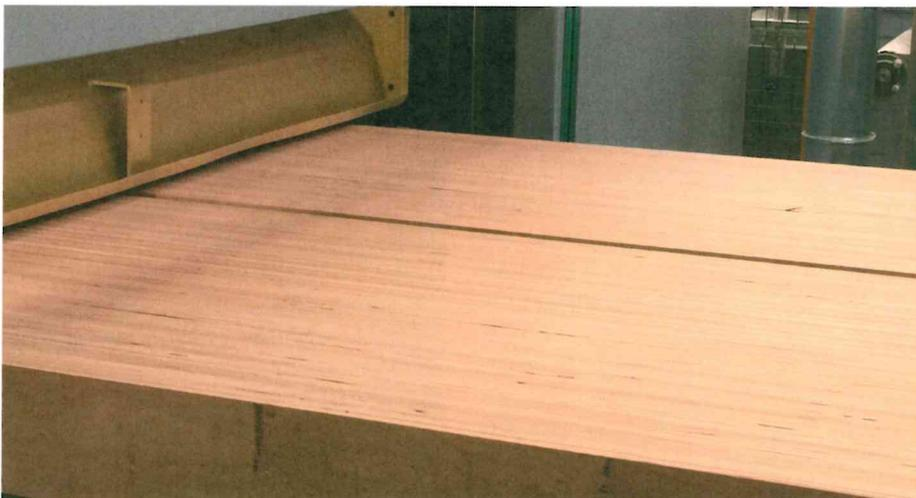
Die Baubuche-Träger beim Verlassen der Schleifmaschine. Sie können im Anschluss wieder zu Paneelen aufgetrennt werden. Daraus entstehen Platten mit stehenden Furnieren.
